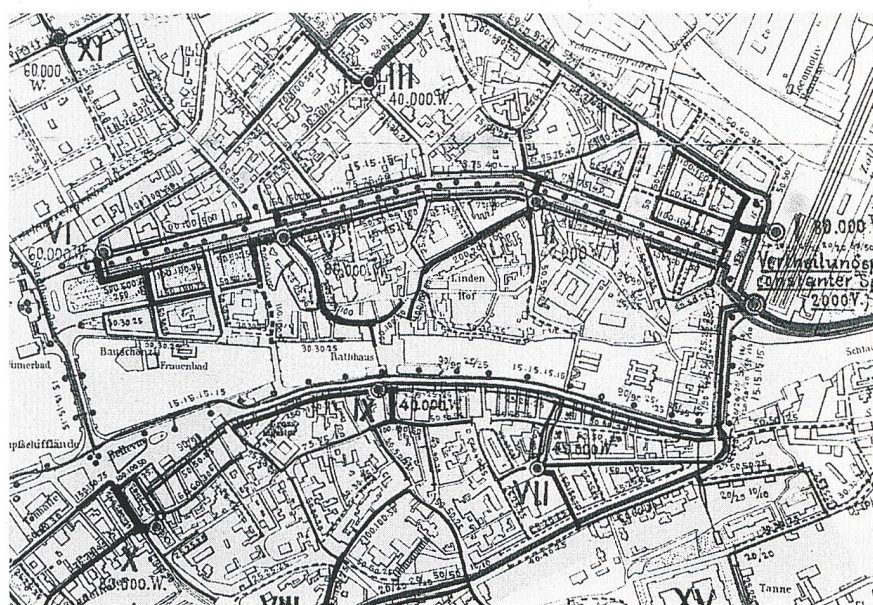
Bild 1 Zur Ortsgeschichte gehört ein Netzplan. Dieser Netzplan vermittelt ein Bild über das Ausmass der ersten drei Ausbaustadien mit Kennzeichnung von Primär- und Sekundärleitungen, Transformatorstationen, ganz- und halbnächtigen Lampen (Zürich)
