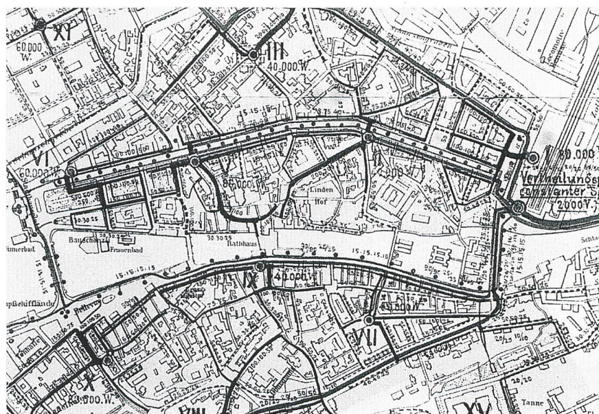
Bild 1 Zur Ortsgeschichte gehört ein Netzplan. Dieser Netzplan vermittelt ein Bild über das Ausmass der ersten drei Ausbautetappen mit Kennzeichnung von Primär- und Sekundärleitungen, Transformatorstationen, ganz- und halbnächtigen Lampen (Zürich)
