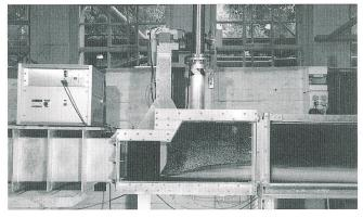
Bild 7 Detailaufnahme der Schützenkammer. Die Fliessrichtung des Wasser ist von links nach rechts. Das Wasser schiesst mit einer Geschwindigkeit von etwa 10 m/s unter der Schütze hervor. Der Wasserstrahl weist eine hohe Turbulenz auf, wodurch Luft in den Wasserstrahl eingemischt wird. Die Belüftungsleitung ist rechts vom Schützenschacht zu sehen.
