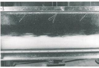
Bild 8 Wasser-Luft-Gemisch: Abfluss im Grundablassstollen (Schützenöffnung 50 mm, Wasserabfluss 170 l/s). Die Fäden weisen nach links, entgegen der Strömungsrichtung des Wasser-Luft-Gemisch-Abflusses (Fotos VAW)
