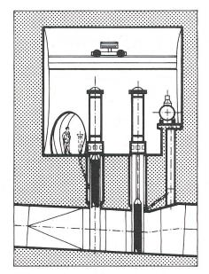
Bild 2 Typische Grundablass-Schützenkammer mit Revisions-, Regulierschütze und Belüftungsleitung
