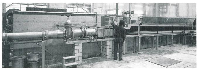
Bild 6 Gesamtansicht des Versuchsstandes «Grundablassstollen». Die Fliessrichtung des Wasser ist von links nach rechts. Der Übergang vom Druckabfluss zum Freispiegelabfluss erfolgt bei der Regulierschütze. Infolge der Luftaufnahme des Wasserstrahls nach der Regulierschütze ist der Abfluss gut als weisse Linie erkennbar (Gefälle 2%, Länge 21 m, Breite 0,30 m, Höhe 0,45 m)
