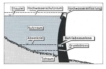
Bild 1 Möglichkeiten der Wasserspiegelregulierung bei einer Staumauer mit Hochwasserentlastung, Betriebsauslass und Grundablass
