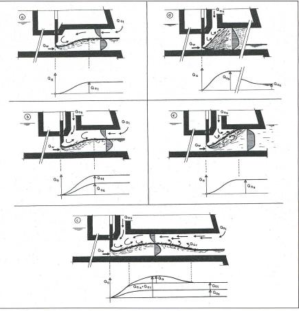
Abflussverhältnisse sowie Be- und Entlüftungsmechanismen in einem Grundablassstollen
