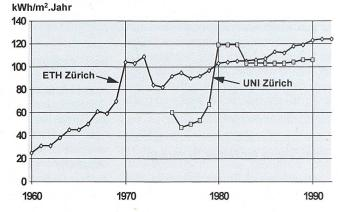
Bild 13 Stromverbrauch pro Energiebezugsfläche an der ETH und der Universität Zürich
