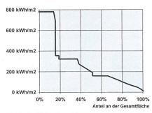
Bild 7 Profil der Energiekennzahl Elektrizität (der Grösse nach geordneter Verbrauch pro Bruttogeschossfläche einzelner Gebäude mit Angabe der jeweiligen Geschossflächenanteile) einer Grossbank
