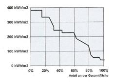
Bild 10 Profil der Energiekennzahl Elektrizität der Lebensmittelläden eines Grossverteilers
