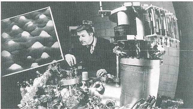
Tieftemperatur-Raster-Tunnelmikroskop und elektronisch aufbereitete Abbildung von leuchtenden, in eine Goldoberfläche eingebetteten C_{60} -Molekülen
