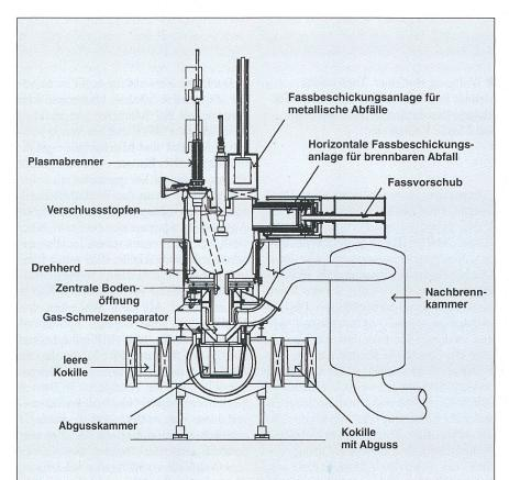
Bild 1 Querschnitt durch den Plasma-Drehherdofen
