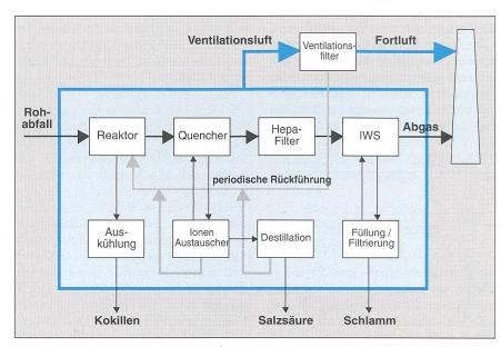
Bild 4 Rauchgas- und Restwasserbehandlung in der Plasmarc-Anlage
