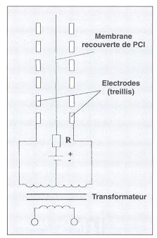
Figure 16 Haut-parleur électrostatique Illustration schématique d'un haut-parleur électrostatique utilisant une membrane avec 0,1 μm de polyaniline sur 6 μm de polyester
