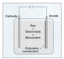
Figure 5 Schéma d'une électropolymérisation
