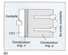
Figure 11 Structure d'une cellule photovoltaïque organique p–n double couche
