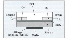
Figure 8 Transistor à effet de champs
