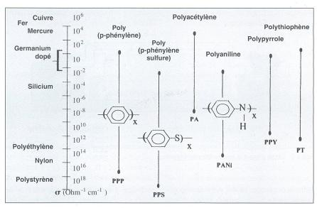
Figure 4 Conductivité électrique de polymères conducteurs
