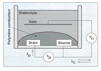
Figure 13 Représentation schématique d'un senseur électrochimique
