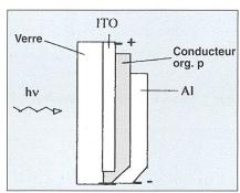
Figure 10 Structure d'une cellule photovoltaïque organique Schottky
