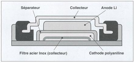
Figure 7 Coupe d'une pile bouton lithium/polyaniline
