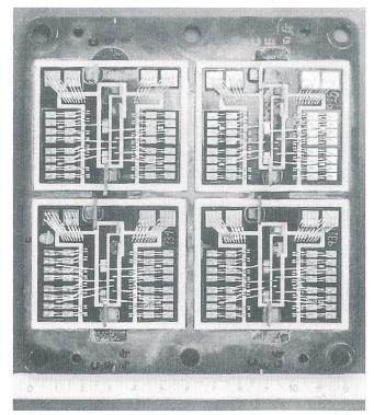
Bild 14 Geöffneter IGBT-Baustein
