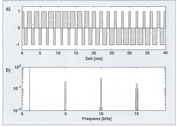
Bild 9 Übliche Art der Wechselspannungserzeugung
