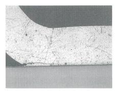
Bild 15 Beginn des Risswachstums an einer Bondierstelle
