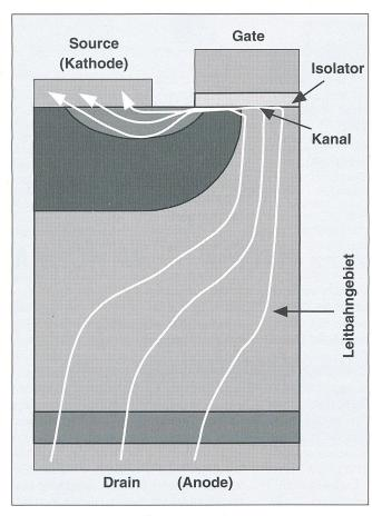
Bild 1 Struktur eines Leistungs-MOS-Transistors
