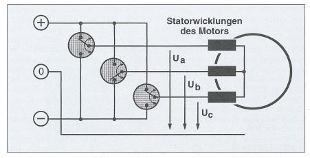
Bild 8 Dreiphasiger Zweipunkt-Wechselrichter
