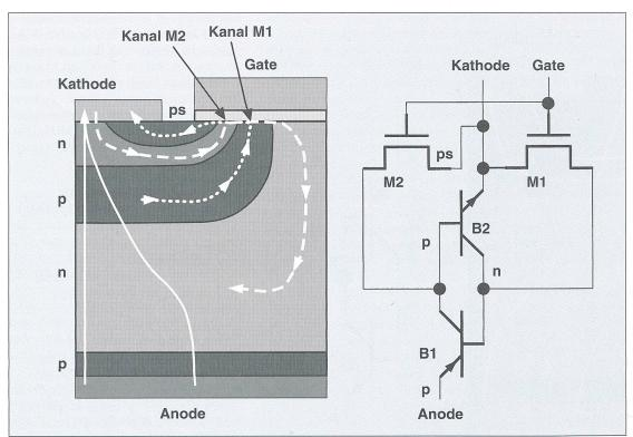
Bild 3 Struktur und Ersatzschaltbild eines MCT
