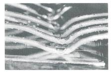
Bild 16 Seitenaufnahme von Drahtbonds nach Lastwechseltest
