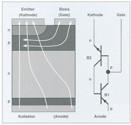
Bild 2 Struktur und Ersatzschaltbild eines GTO
