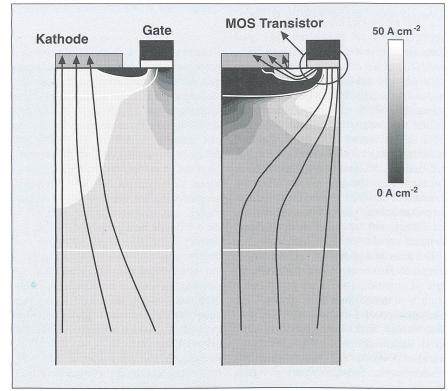
Bild 4 Stromdichteverteilung in einer MCT-Zelle
