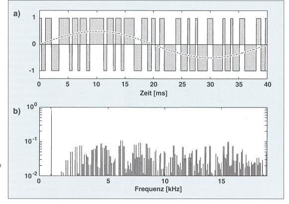
Bild 10 Optimiertes Modulationsverfahren zur Geräuschreduktion
