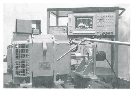
Bild 11 Geräuschmessung am Motor
