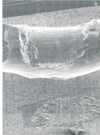
Bild 17 Rasterelektronenmikroskopische Aufnahme einer abgescherten Bondierung
