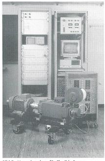
Bild 7 Versuchsanlage für Flexible Power Management
