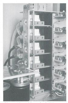
Bild 6 Umrichter-Brückenzweig mit IGBT-Reihenschaltung
