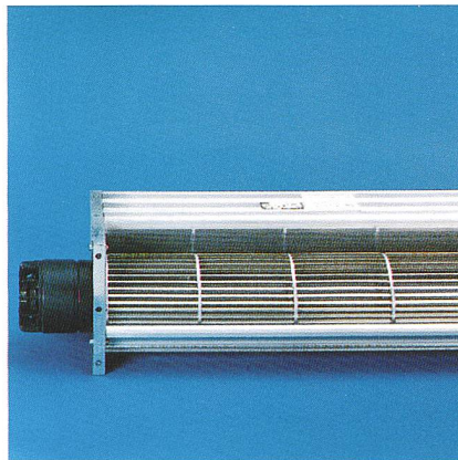
Querstromgebläse AL 6.1 Bis 3'000 m 3 /h, Walzendurchmesser 60/80/100/120 mm und Längen bis 1200 mm, 90° oder 180° durchströmt, auch als 19"-Einheit. Ventilateurs tangentiels Débits jusqu'à 3'000 m 3 /h, diamètre des turbines 60/80/100/120 mm, longueur jusqu'à 1200 mm, déviation du flux d'air à 90° ou 180°, existe également au standard 19".
