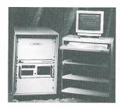
Das vollautomatische Wicklungsprüfsystem AST 8800
