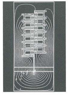
Figure 8 Distribution des équipotentielles dans un générateur de Marx
