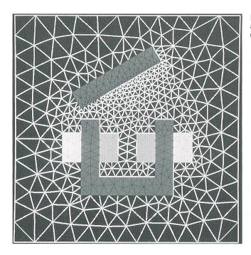
Figure 2 Maillage automatique d'un contacteur
