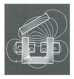
Figure 5 Distribution des équipotentielles dans un contacteur
