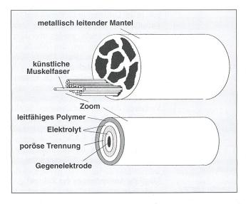
Bild 15 Muskelähnlicher elektromechanischer Aktor
