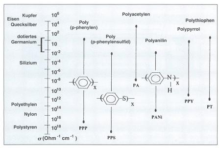
Bild 4 Elektrische Leitfähigkeit leitender Polymere
