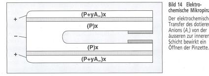
chemische Mikropinzette Der elektrochemische Transfer des dotierenden Anions (A\_) von der äusseren zur inneren Schicht bewirkt ein
