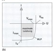
Bild 12 Strom-Spannungs-Kennlinie einer Fotodiode
