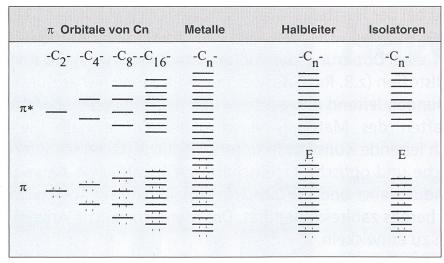
Bild 2 Entwicklung der Energiebänder in Polymeren bei zunehmender Anzahl Doppelbindungen
