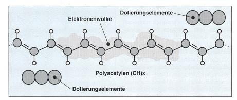
Bild 1 Elektronen-Delokalisierung in einer Polyacetylen-Kette
