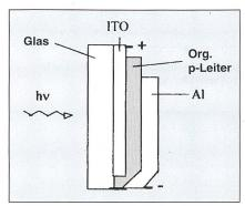
Bild 10 Struktur einer organischen Schottky-Zelle im Querschnitt
