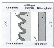
Bild 9 Querschnitt durch einen Polypyrrol-Elektrolyt-Kondensator
