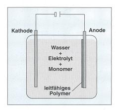
Bild 5 Schematische Darstellung der Elektropolymerisation von ILP
