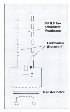
Bild 16 Elektrostatischer Lautsprecher
