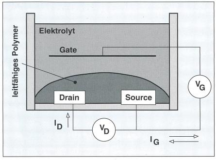
Bild 13 Schematische Darstellung eines elektrochemischen Sensors
