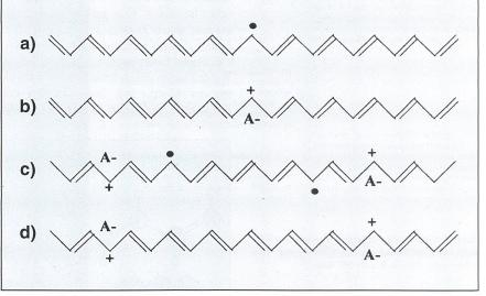
Bild 3 Polyacetylen mit möglichen Fehlstellen
