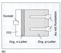
Bild 11 Struktur einer organischen p-n-Fotozelle
