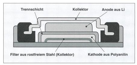
Bild 7 Lithium/Polyanilin-Knopf-Batterie im Querschnitt
