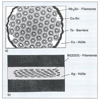
Bild 4 Verschiedene Konfigurationstypen für klassische und HTC-Multifilament-Supraleiter
