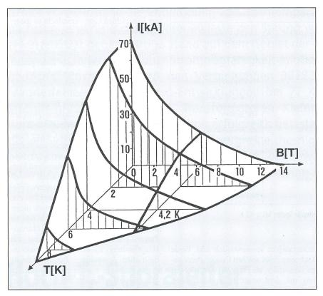
Bild 1 Kritische Fläche eines Supraleiters
