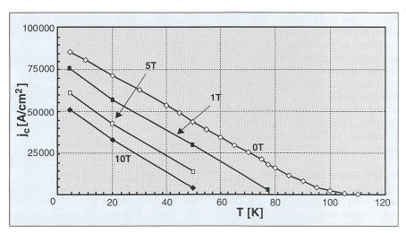
Bild 9 Kritische Stromdichte  $j_c$  von Bi(2223)-Bändern als Funktion der Temperatur für verschiedene Magnetfelder B für die Orientierung von B senkrecht zu c (G. Grasso et al. [4])
