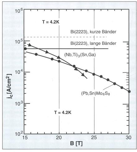
Bild 8 Kritische Stromdichten verschiedener Supraleiter
