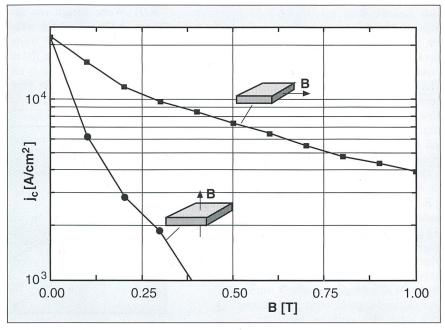
Bild 7 Kritische Stromdichte eines langen, gewalzten Bi(2223)-Bandes
