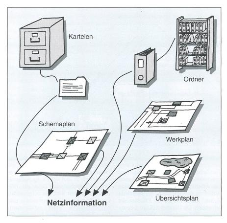
Bild 1 Elemente der Netzinformation
