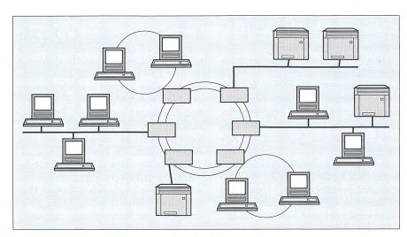
Bild 7 FDDI Connectivity (Grossrechner und Peripherie)
