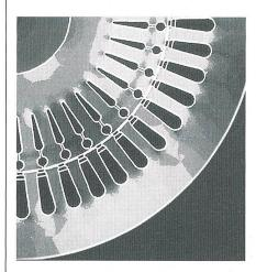
La méthode des éléments finis constitue aujourd'hui un outil important dans la conception assistée par ordinateur et la simulation numérique de systèmes électromagnétiques. La photo montre la distribution des inductions dans une machine asynchrone pendant le démarrage (couleurs claires: induction magnétique élevée); voir page 41.
