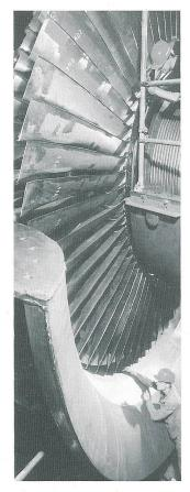
Niederdruck-Dampfturbinen-Laufrad wie für das KKW Isar 2 vorgesehen
