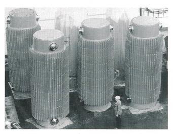
Beispiel für Behälter, die sowohl für den Transport als auch für die Lagerung stark radioaktiver Materialien konzipiert werden. Die charakteristischen Kühlrippen dienen der besseren Ableitung der Wärme an die Umgebungsluft
