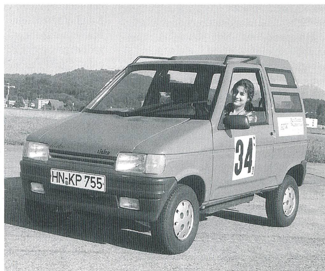
Bild 2 Der Ligier «Optimax» ist mit einem Asynchronmotor ausgerüstet und bietet mit nur 2,5 m Länge erstaunlich viel Laderaum
