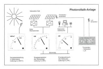
gieproduktion über den Impulskontakt eines *Energiezählers* erfasst. Gegebenenfalls (bei nur einem Wechselrichter) kann die Erfassung der momentan erzeugten Leistung durch den Stromwandler entfallen. Diese wird dann indirekt über die Anzahl der Zählerimpulse pro Zeiteinheit bestimmt.
