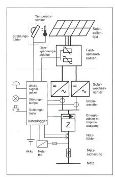
Bild 1 Prinzipschaltbild der Überwachungseinrichtung
