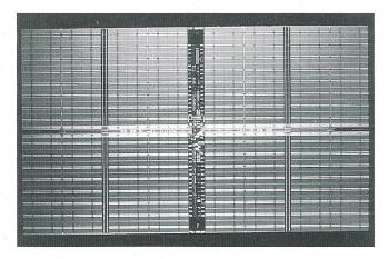
Von Siemens und IBM entwickelter 64-MBit-DRAM-Baustein
