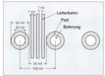
Bild 7 Leiterbahnen zwischen zwei Pins (1 mil = 1/1000 Zoll = 25,4 μm)
