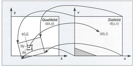
Bild 1 Beispiel einer Bildvergrösserung und -drehung mit bilinearer Interpolation und Clipping
