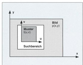
Bild 4 Geometrische Verhältnisse zwischen Bild, Suchbereich und Muster
