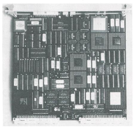
Bild 6 Warper- und Korrelatormodul für Sydama-2
