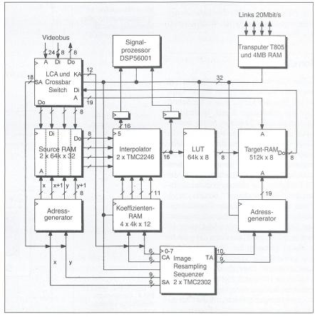
Bild 5 Blockschaltbild des Warpers und Korrelators
