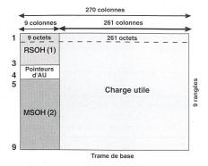
Figure 1 Trame de base (durée 125  $\mu$ s)
