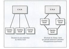
Figure 5 Réseau local: raccordement des centres locaux
