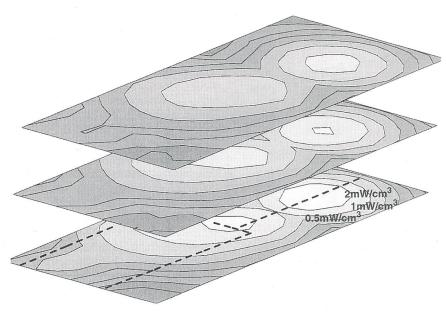
Bild 2 SAR-Verteilung des Gerätes Nr. 4 in drei Ebenen im Gewebe
