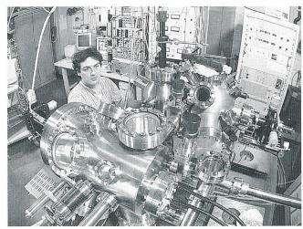
In kompakter Ultrahochvakuum-Anlage integriertes Rasterkraftmikroskop
