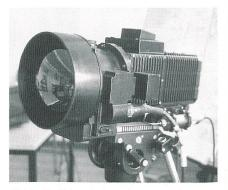
Bild 2 Hochleistungsthermalscanner JR18
