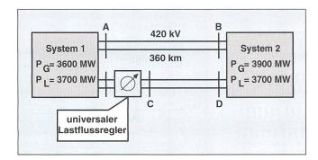
Bild 12 Schematische Schaltung des untersuchten Verbundnetzes
