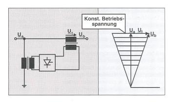
Bild 7 Schematische Darstellung eines universalen Lastflussreglers und sein Betriebsdiagramm
