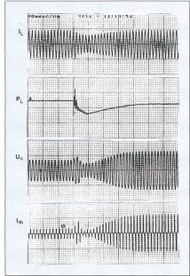
Bild 10 Lastflussänderung durch die regelbare Reihenkompensation
