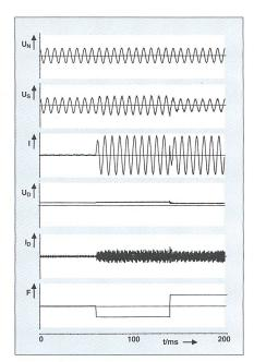
Bild 9 Verhalten eines 24pulsigen GTO-Kompensators am Netz bei einer Blindleistungs-Sollwert-Änderung
