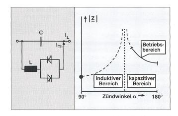
Bild 5 Schematische Darstellung eines GTO-Serienkompensators und sein Betriebsdiagramm siehe Text
