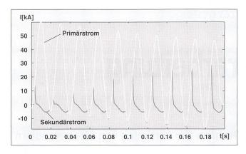
Bild 2 Vergleich von Primär- und Sekundärstrom eines Stromwandlers bei starker Sättigung
