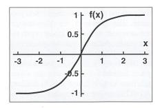
**Bild 7 Transferfunktion der Mittelschicht**Für die Mittelschicht wird eine sigmoide Aktivierungsfunktion f(x) = tanh(x) eingesetzt
