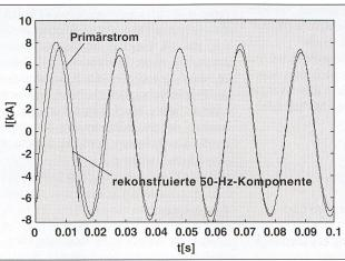
Bild 10 Primärstrom und gesättigter Sekundärstrom für ein Beispiel aus der Lerndatenmenge Wandler 5P5,  $I_{max}=15$ kA,  $\alpha=0$
