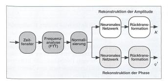
Bild 4 Verarbeitungsschritte zur Rekonstruktion des Primärstroms
