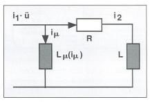
Bild 8 Für die Simulation benütztes Wandlermodell
