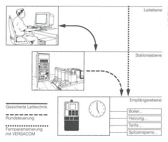
Bild 2 «Verteilte Intelligenz» mit dem Rundsteuersystem S.P.I.D.E.R. LMS
