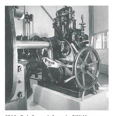
Bild 8 Technik zum Anfassen im BKW-Museum: Regler einer Turbinen-Generatorgruppe aus dem alten Kraftwerk Spiez
