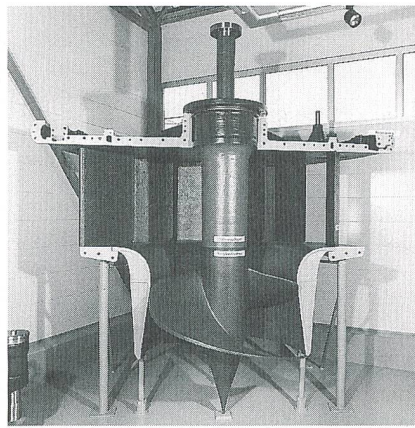
Bild 6 Im BKW-Museum ausgestellt: Extra-Schnelläufer-Turbine («Schraubenturbine») aus dem alten Kraftwerk Matte/Bern
