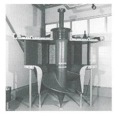
Bild 6 Im BKW-Museum ausgestellt: Extra-Schnelläufer-Turbine («Schraubenturbine») aus dem alten Kraftwerk Matte/Bern
