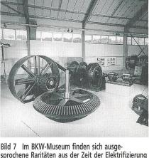
Bild 7 Im BKW-Museum finden sich ausgesprochene Raritäten aus der Zeit der Elektrifizierung (Langsamläufer-Turbine mit Holzzahn-Kammradgetriebe und Lederriemen-Übersetzung)
