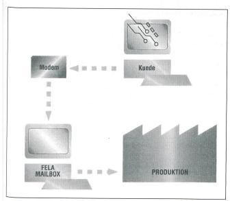
Vom Konstruktionscomputer per Telefon in die CAM-Aufbereitung
