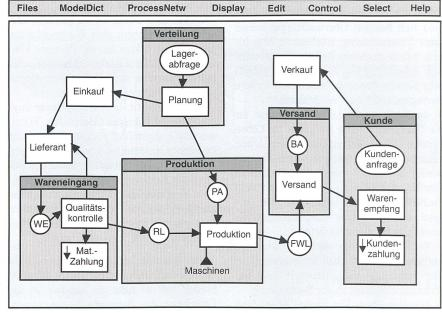
Bild 5 Beispiel eines Prozessnetzwerkes einer modellierten Unternehmung
