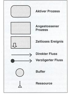
Bild 3 Die sieben Elemente zur Bildung von Prozessnetzwerken
