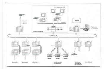
Anlagenkonzept für integrierte Leittechnik im Wasserkraftwerk
