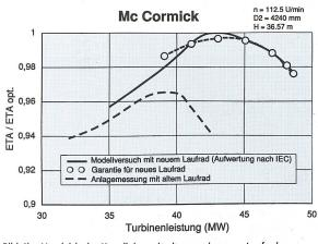
Bild 4b Vergleich der Kennlinien mit altem und neuem Laufrad (ohne Änderung der nichtrotierenden Komponenten)
