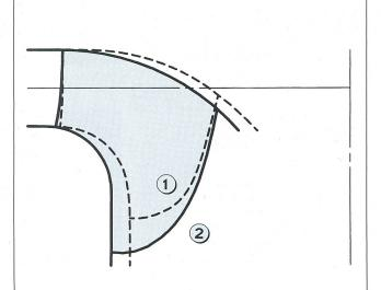
Bild 5a Meridiankontur für Såheim Nr. 3 mit altem Laufrad (1) und neuem Laufrad (2, blau) bei gleichzeitiger Erneuerung des Saugrohres
