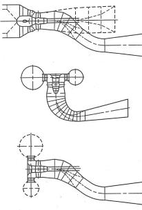
Bild 1 Für S- oder Rohrturbinen (oben) oder Kaplanturbinen (Mitte) sind Laufradprofile in der Modelldatenbank vorhanden; für die Zwitterlösung von Swift Rapids Nr. 3 (unten) wurden jedoch rein numerisch entwickelte neue Laufräder (ohne Modellversuch) eingebaut
