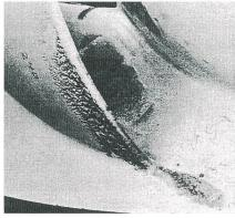
Erosionsbild an der Anlage (Austritt)
