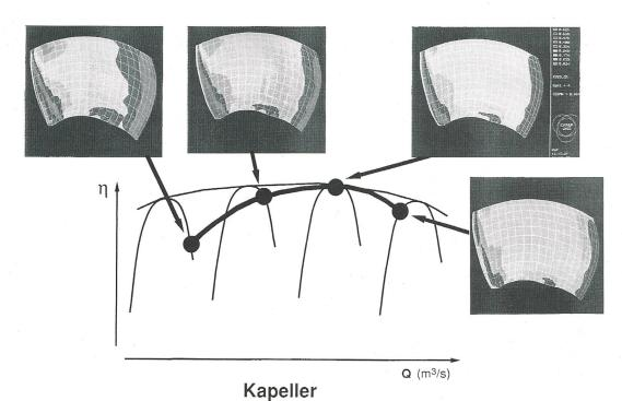
Bild 3 Berechnete Druckverteilung auf der Schaufel-Saugseite bei festem Leitradreguliertem Laufrad (Swift Rapids Nr. 1 und 2)
