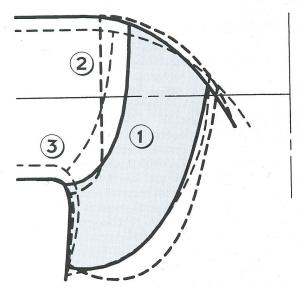
Bild 4a Meridiankontur des massgeschneiderten neuen Laufrades McCormick (1, blau) im Vergleich zum alten Laufrad (2) und zu einer Standard-Kontur (3) gleicher spezifischer Drehzahl
