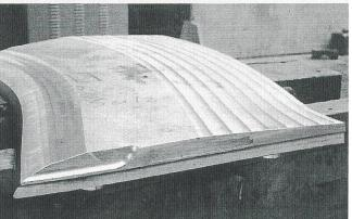
Bild 7 Gefrästes Schaufelblech vor dem Pressen
