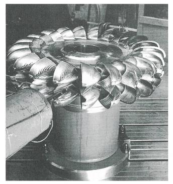
Bild 2 Aussenvolumen der Becher werden microgegossen und anschliessend allseitig gefräst und geschliffen
