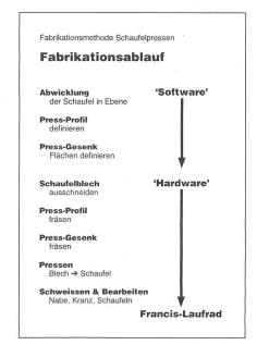
Bild 6 Fabrikationsablauf Schaufelpressen: «Software»
