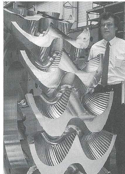
Titelbild: Moderne Fertigung von Wasserturbinen-Laufrädern: Die innenliegende Radkontur dieses Peltonrades wird mit Roboter aus dem Vollen herausgearbeitet, anschliessend folgt das Mikroguss-Aufschweissen der Aussenvolumen
