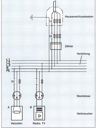
Bild 3 Installationsart mit Schutzerdung
