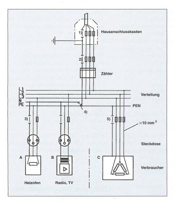
Bild 4 Installationsart TN-C-S (Schema II)
