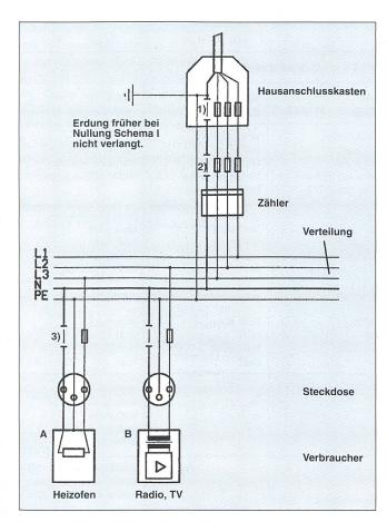
Bild 2 Installation TN-S (früher Nullung Schema I)
