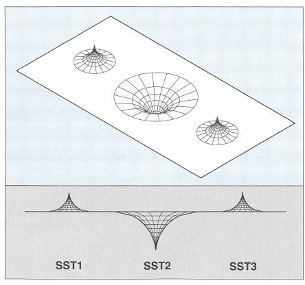
Bild 7 Bei den Unterwerken durch die ein- oder austretenden Erdströme erzeugte Potentialtrichter Der Trolleybus steht vor dem Unterwerk 2 SST1, SST2, SST3 Position der Unterwerke 1, 2 und 3
