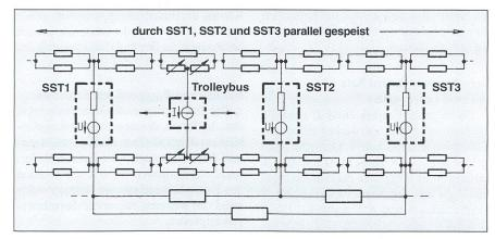
Bild 2 Elektrisches Ersatzschaltbild eines Trolleybusnetzes mit zweiseitiger Einspeisung ST1, SST2, SST3 Unterwerke 1, 2 und 3
