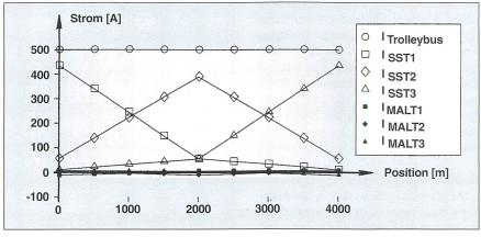
Bild 5 Stromverläufe in Funktion der Fahrzeugposition für den Fall dreier Unterwerke
