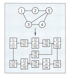
Bild 3 Mathematisches Modell des Trolleybusnetzes
