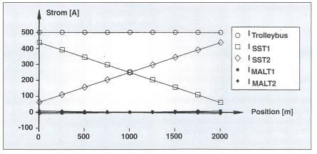
Bild 4 Stromverläufe in Funktion der Fahrzeugposition für den Fall zweier Unterwerke
