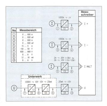
Bild 9 Schematische Darstellung der Messeinrichtungen in einem Unterwerk
