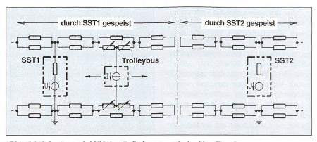
Bild 1 Elektrisches Ersatzschaltbild eines Trolleybusnetzes mit einseitiger Einspeisung SST1, SST2 Unterwerke 1 und 2
