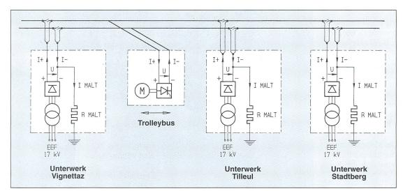
Bild 10 Schematische Darstellung der durchgeführten Messungen
