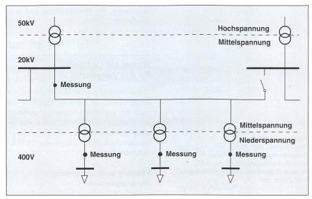
Bild 1 Schema eines Abganges mit Messstellen
