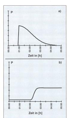
Bild 4 Modellkurven für die von der Rundsteuerung ausgelösten Lasten
