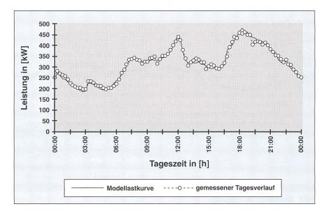
Bild 10 Modellastkurve im Vergleich zum gemessenen Tagesverlauf
