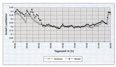
Bild 7 Unterschiede zwischen Sommer- und Winterlastfaktoren
