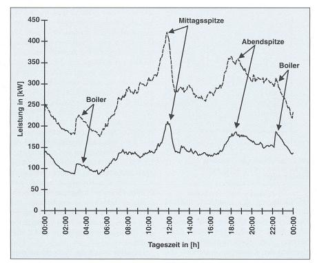
Bild 2 Tagesbelastungskurven zweier benachbarter Verteiltransformatoren
