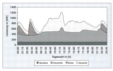
Bild 11 Lastzusammensetzung an einem Verteiltransformator
