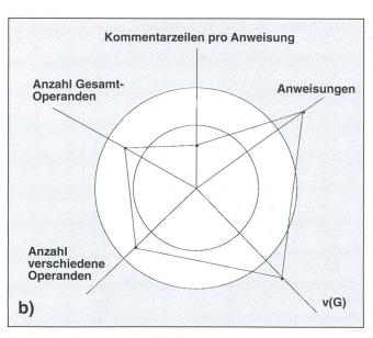
Bild 4b Kiviat-Diagramm mit Soll-Bereich
