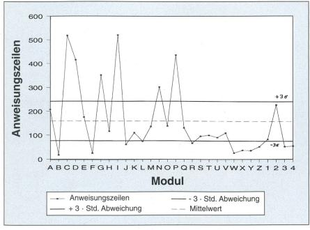
Bild 3 Schwachstellen erkennen: Grössen von Moduln
