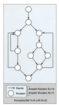
Bild 2 Zyklometrische Komplexität eines Programmgraphen
