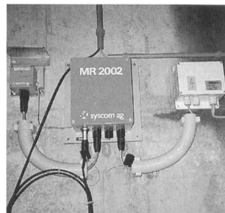
Bild 3 Einer der zwölf in der Mauvoisin-Mauer installierten seismischen Beschleunigungsmesser
