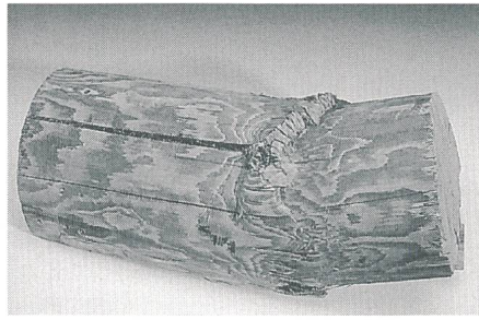
Bild 6 Verformung nach Plastifizierung eines auf Biegen getesteten Holzmastes
