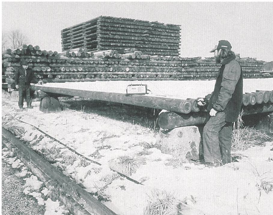
Bild 8 Qualitätsbestimmung eines Holzastes mit dem Ultraschallgerät Sylvatest®
