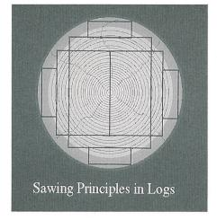
Bild 4 Sägeprinzip beim runden Querschnitt in der Industrie zur ersten Verarbeitung
