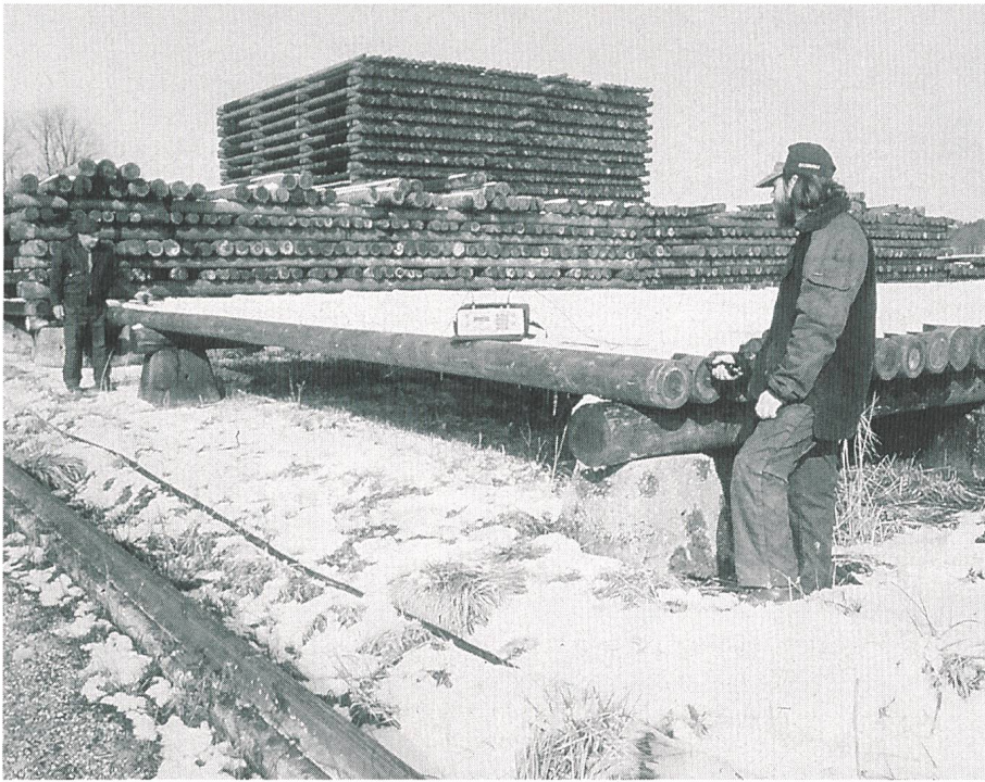
Bild 8 Qualitätsbestimmung eines Holzmaßes mit dem Ultraschallgerät Sylvatest®
