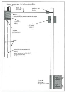
Bild 5 Statisches System des Holzmastes beim Biegetest: es simuliert einen eingespannten und durch horizontale Windkraft beanspruchten Mast
