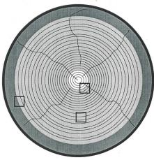
Bild 3 Entnahmestellen der Holzwürfel zur Bestimmung der Dichte beim Rundholz
