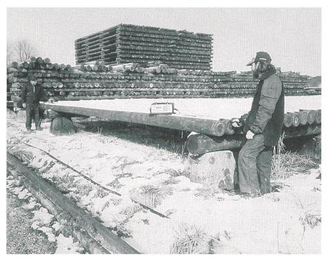
Bild 8 Qualitätsbestimmung eines Holzmastes mit dem Ultraschallgerät Sylvatest®
