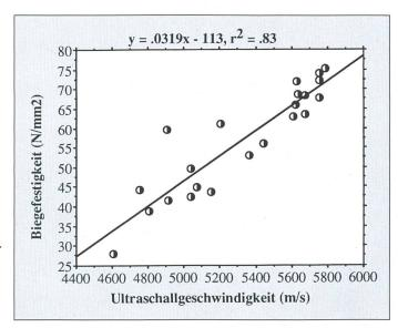
Bild 7 Zusammenhang zwischen Fortpflanzungsgeschwindigkeit des Ultraschalls und Biegewiderstand von Telefonstangen von 7 bis 8 m Länge
