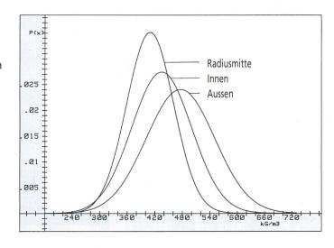
Dichte nimmt vom Mark zum Splint des Baumes zu. Bild 2 zeigt die Entwicklung der Dichte an hundert getesteten Masten. Die drei analysierten Dichten entsprechen den drei Entnahmen gemäss Bild 3, je einem Testwürfel aus der Marknähe, aus der Radiusmitte und aus der Randregion.
