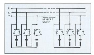
Bild 2 Statischer Blindleistungskompensator mit thyristorgeschalteten Kondensatoren
