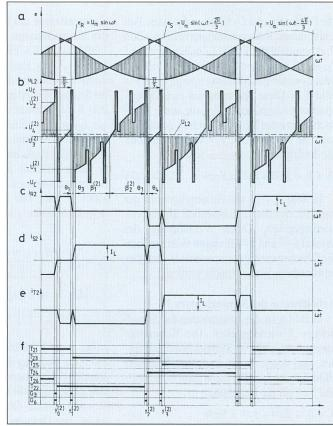
Bild 5 Funktionsprinzip des Stromrichters 2
