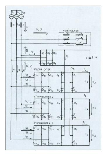
Bild 3 Neuer statischer Blindleistungskompensator
