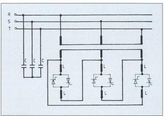
Bild 1 Statischer Blindleistungskompensator mit thyristorgestellter Drosselspule (TCR)
