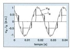
Figure 6 Tension  $u_a$  et courant  $i_a$  de phase du convertisseur C1
