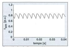
Figure 18 Couple électromagnétique  $t_{em}$  de la machine asynchrone
