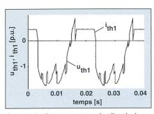
Figure 5 Tension  $u_{th1}$  et courant  $i_{th1}$  d'un thyristor du convertisseur C1
