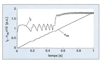
Figure 9 Courant d'excitation  $i_f$  et vitesse de rotation  $n_m$  de la machine synchrone
