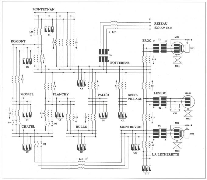
Figure 11 Réseau 60 kV des EEF, partie Sud
