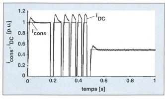
Figure 10 Consigne de courant  $i_{cons}$  et courant  $i_{DC}$  du circuit intermédiaire
