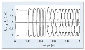
Figure 7 Courants  $i_a$ ,  $i_b$  et  $i_c$  des phases statoriques de la machine synchrone
