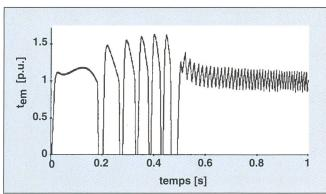
Figure 8 Couple électromagnétique  $t_{\it em}$  de la machine synchrone
