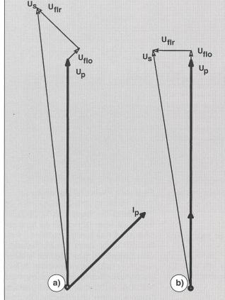
Bild 6 Vektordiagramm für Fahrzeuge mit 4QS und mit Anschnittsteuerung
