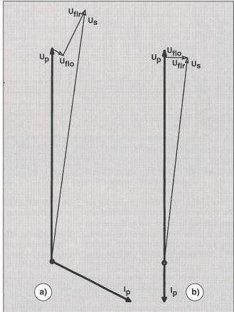
Bild 7 Vektordiagramm für Fahrzeuge bei Rekuperation mit schlechtem Leistungsfaktor und mit  $\lambda$  = 1
