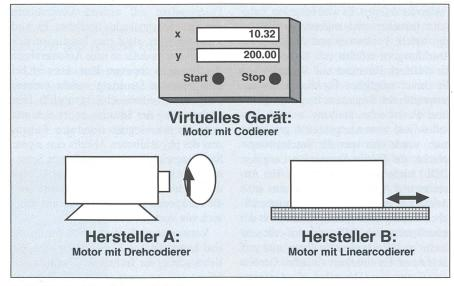
Bild 3 Virtuelles Feldgerät und reale Geräte
