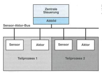
Bild 2 Zentrale Steuerung mit Sensor-Aktor-Bus
