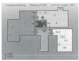
Bild 3 Stromaustausch in Europa (Austauschleistung an einem Sommertag)
