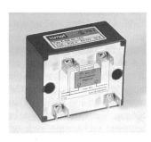
gegenüber dem extrem hohen Einschaltstromstoss, der je nach Phasenlage das 100fache des Nennstromes erreichen kann, wird durch einen Einschaltstrombegrenzer ideal gelöst. Beim Einschalten ist die Last mit einem Dämpfungswiderstand in Reihe geschaltet; dieser verhindert das zu hohe Ansteigen des Einschaltstromes und verkürzt dessen zeitlichen Verlauf. Der Einschaltstrombegrenzer ist für Nennspannungen von 230 bis 400 V und für einen Dauerstrom von maximal 16 A ausgelegt.
