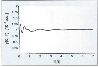
Figure 9 Réponse indicielle du niveau suite à un saut de perturbation de 0,1 p.u.
