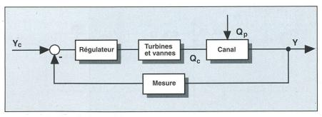
Figure 1 Schéma de principe du réglage du niveau en amont d'un barrage au fil de l'eau
