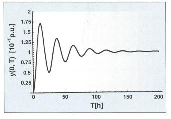
Figure 11 Réponse indicielle du niveau suite à un saut de perturbation de 0,1 p.u.
