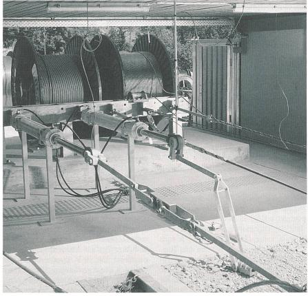
Bild 5 Freiluftprüfstand Cossonay für Prüflängen bis 300 m
