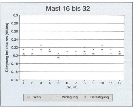
Bild 6 Lichtwellenleiter-Endprüfung
