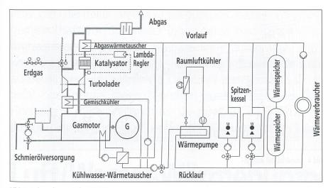
Bild 2 Anlagenkonzept des BHKW
